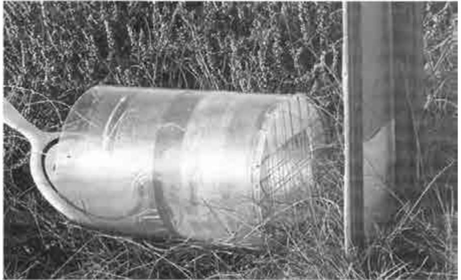
Abb. 5: Strukturmessröhre zur Schätzung der horizontalen Vegetationsdichte. Photo: D. Hoffmann.
