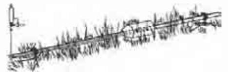
Abb. 7: Messung des Raumwiderstandes der Vegetation. Gemessen wird die benötigte Kraft, um einen Körper auf einer Schiene gleichmäßig durch die Vegetation zu ziehen.
