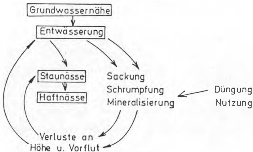
Abb. 3: Die Entwicklung eines grundnassen Moorbodens zum stauhaftnassen Problemstandort durch intensive Entwässerung und Nutzung (Kuntze et al., 1988)
