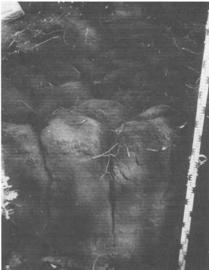
Abb. 5: Schwundspalten im Moorkörper (Vermulmungs- und Torfbröckelhorizont wurden entfernt)
