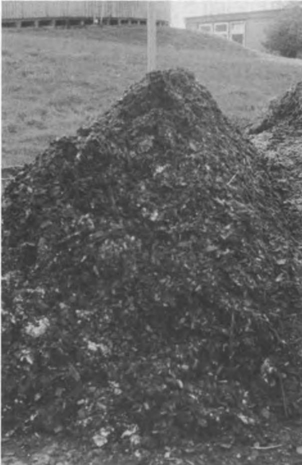
◇ **Abb. 6: Entwässerter Schlamm mit Sickerschicht als Schüttgut zum Kompostieren und Hygienisieren.**
