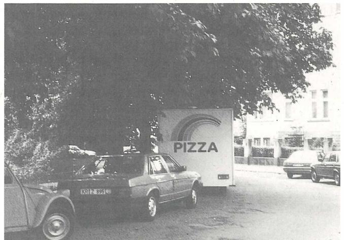
**Abb. 4.** Wird das Lichtraumprofil in Verkehrsstraßen nicht freigehalten, haftet u. U. die Behörde für Schäden an LKW. In untergeordneten Straßen reicht ggf. eine Beschilderung aus.
