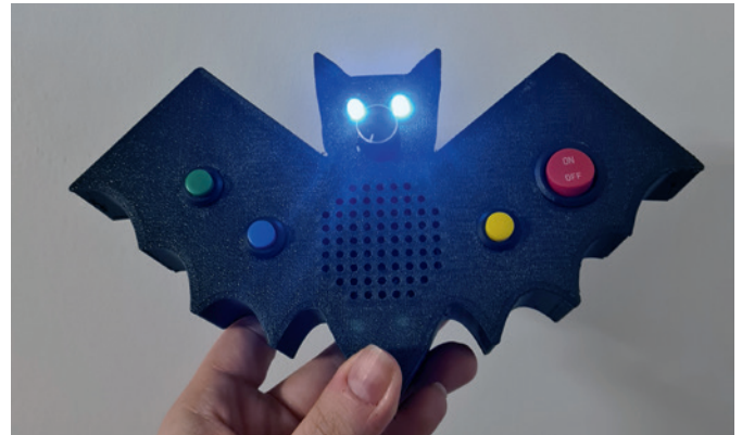
Abbildung 3: B@t-Detektor bestückt und eingeschaltet. Passend zum eingehenden Ultraschallsignal zwinkert die Fledermaus mit den Augen und vibriert gleichzeitig. Über einen eingebauten Lautsprecher werden die Fledermausrufe hörbar. Alle Funktionen können zu- und ausgeschaltet werden. Foto: A.-K. Krebs
