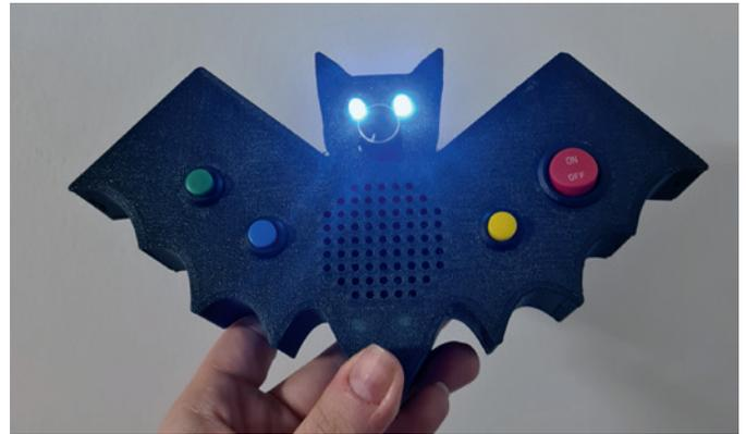
Abbildung 3: B@t-Detektor bestückt und eingeschaltet. Passend zum eingehenden Ultraschallsignal zwinkert die Fledermaus mit den Augen und vibriert gleichzeitig. Über einen eingebauten Lautsprecher werden die Fledermausrufe hörbar. Alle Funktionen können zu- und weggeschaltet werden. Foto: A.-K. Krebs
