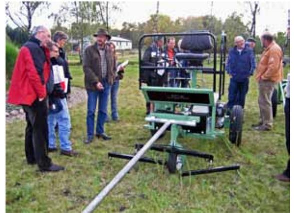
Abbildung 6: Vorderwagen in Frontansicht mit der Deichsel zur Anspannung (Foto: M. Kempken)
