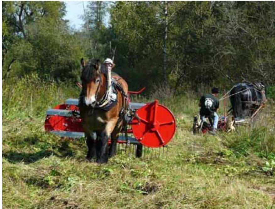
Abbildung 3: Der für Pferdearbeit entwickelte Schwader mit Bodenantrieb wird selbst mit großen Mengen Schnittgut problemlos fertig. (Foto: P. Schmit)
